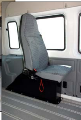
Nedsænkede hjulkasser og Jany 862-stole monteret på hjulkassebro
