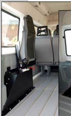
Nedsænkede hjulkasser og Jany 862-stole monteret på hjulkassebro
