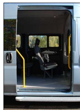
For let og sikker adgang, er der monteret skridsikket trin og kraftige håndbøjler ved skydedøren.
