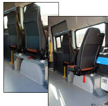
Nedsænkede hjulkasser og Jany 862-stole monteret på hjulkassebro.
