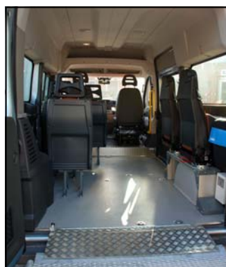
Drejestolene giver en fleksibel bil, med god plads til 2-3 kørestole. Der er lavet gulvkonsoller til fastspænding af kørestole.
