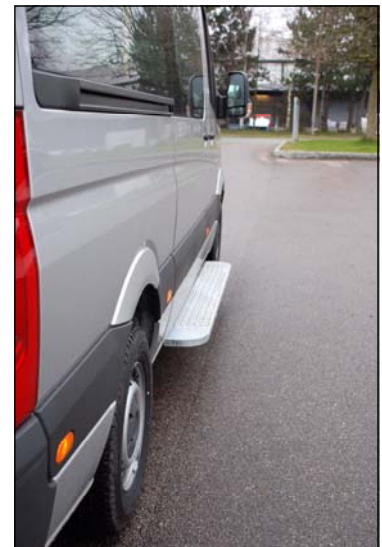
Trin ved skydedør og fordør
