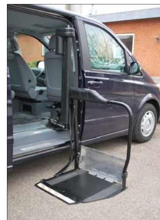
90 kg kran til placering af eks. kørestol i bagagerummet
