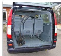
90 kg kran til placering af eks. kørestol i bagagerummet
