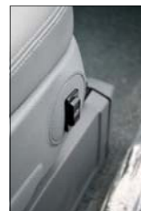
Originalt førersæde ombygget med el-betjent ryglænsjustering.
